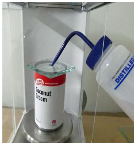
Figura 6. Ajustarea nivelului cu apă și greutate
