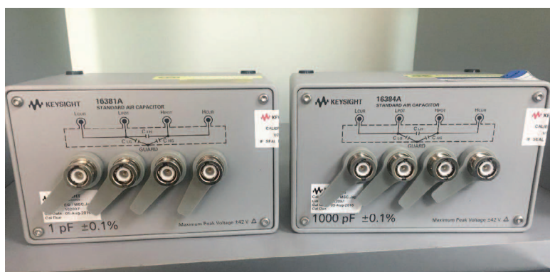
Figura 2. Vederea generală a măsurilor de capacitate electrică
